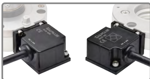
防水電極（非接触防水タイプ） IP67 対応
